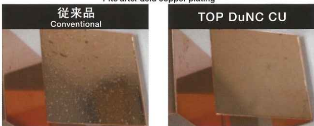
硫酸銅めっきのピット Pits after acid copper plating
