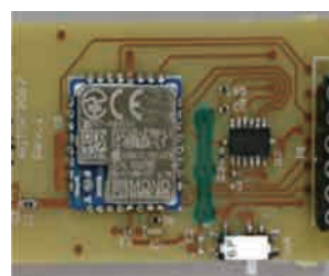
【作製例】 センサーモジュール基板 【Manufacturing example】 Module PCB for sensor
