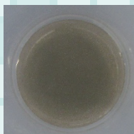
処理 168h Treated product → 変化なし No rust
