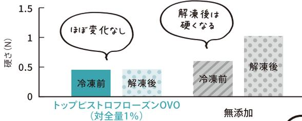
機器: テクスチャーアナライザー測定 (チルド解凍後)
