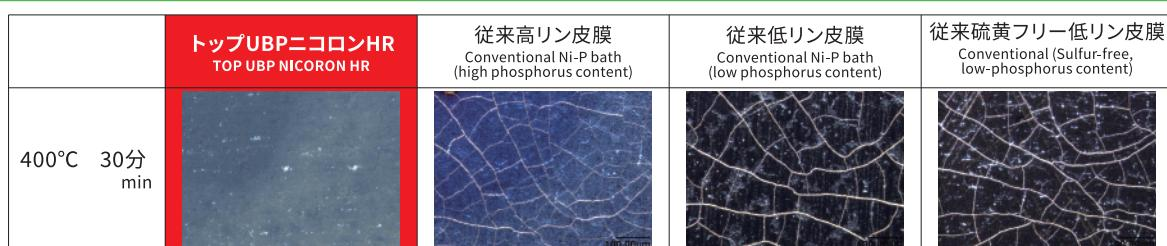
エリクセン塗膜強度試験機による押し込み試験後の外観比較 (ニッケル膜厚:3μm 押し込み幅:0.5mm)
