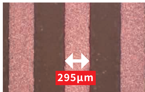
無電解銅めっき後のパターン After electroless copper plating L/S=300μm/300μm
