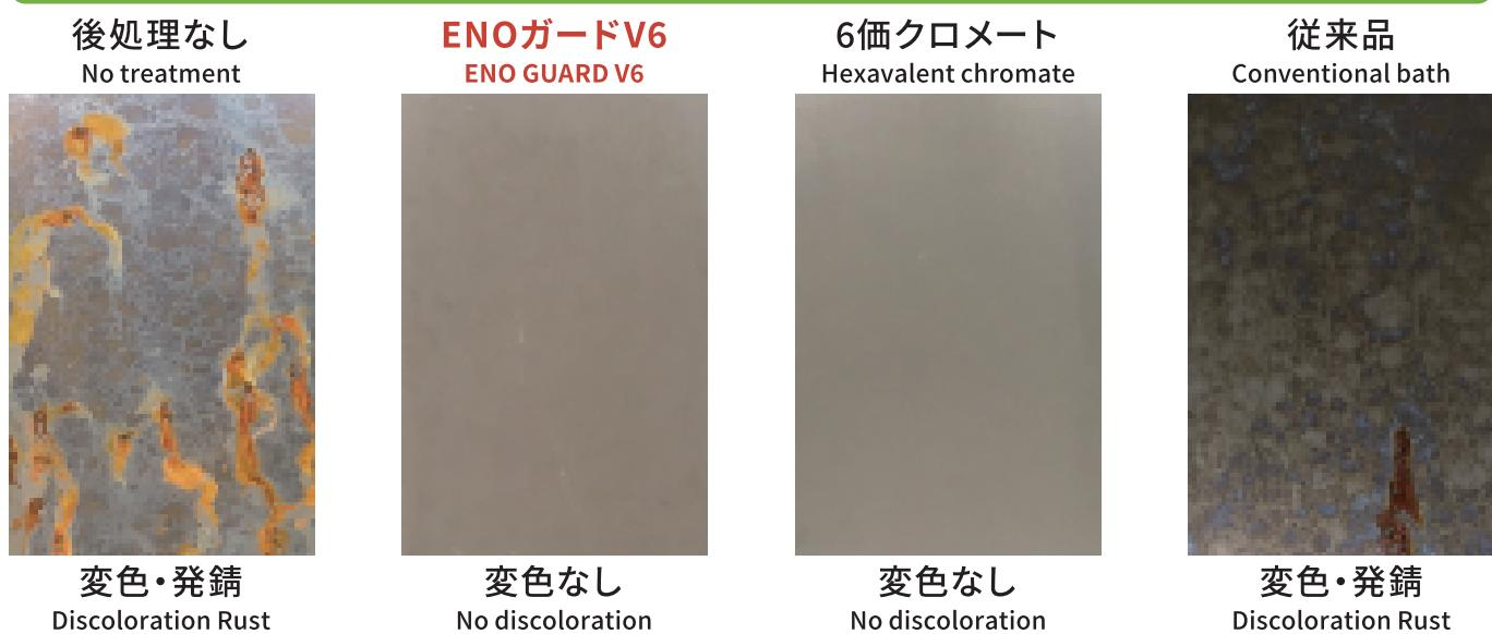
\* 塩水噴霧試験 72 時間、下地：トップニコロンSA-98-LF（高リンタイプ）2.0μm
